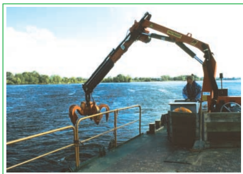
Fot. 7. Pobór prób przy pomocy chwytaka wieloszczękowego z pogłębiarki
