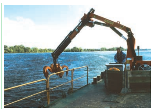
Fot. 7. Odběr vzorku z bagru pomocí polypového drapáku
